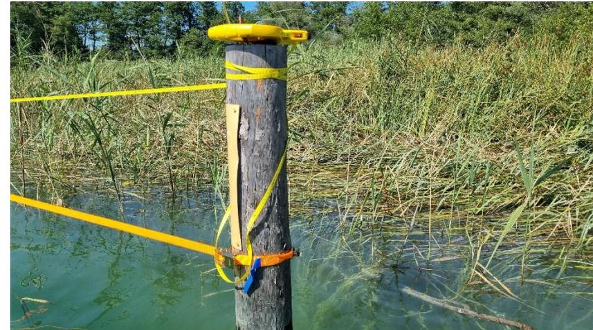
Abbildung 3: Spanngurt und Maßband wurden fest an den Pfosten befestigt.
